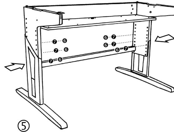
Stecken Sie die Füße seitlich an die Seitenteile und schrauben Sie diese von innen mit den Unterlegscheiben ⑦ und den Rundmutter ⑥ fest. Achten Sie darauf, dass die niedrigere Spitze des Fußseitenteiles vorne ist. Nehmen Sie die Höhenanpassung erst nach der endgültigen Montage vor.
