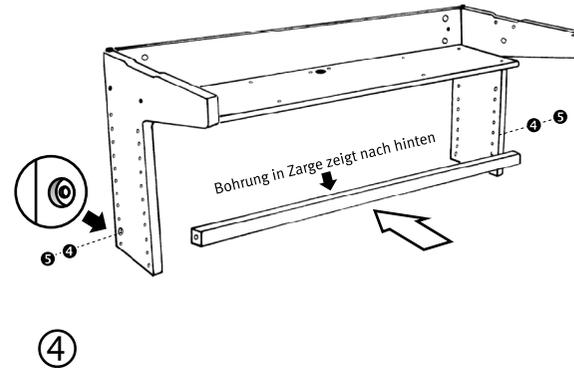
Schieben Sie die Metallzarge mit der Bohrung nach hinten zeigend zwischen die Seitenteile. Stecken Sie die Rosetten ④ in die Stufenbohrlöcher (Skizze) und schrauben anschließend die Zarge beidseitig mit den Senkkopfschrauben ⑤ fest.
