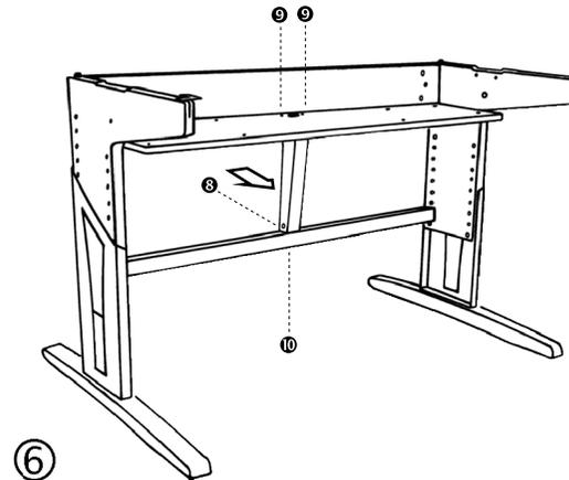
Schieben Sie die Gasdruckfederabdeckung von hinten gegen die Zarge und verbinden die beiden Teile mit der Flachrundschrabe ⑥. Anschließend schrauben Sie von oben durch die beiden Bohrlöcher in der Ablage, die Gasdruckfederabdeckung mit den Senkkopfschrauben ⑨ und der Mutter ⑩ fest.
